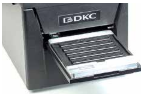
2. Встановити адаптер на напрямні шпунти 2. Install the adapter on the guide pins
