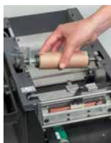
Встановлення стрічки в принтер Inserting the tape into the printer
