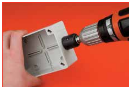
Етап 1. Свердління отворів необхідного діаметра Step 1. Drilling holes of the required diameter
