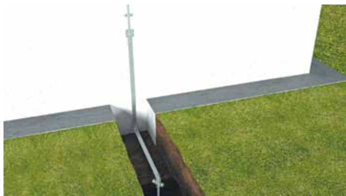
Заземлення струмоспуску Grounding the current release
