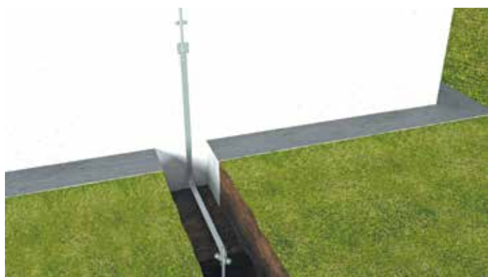
Заземлення струмоспуску Grounding the current release
