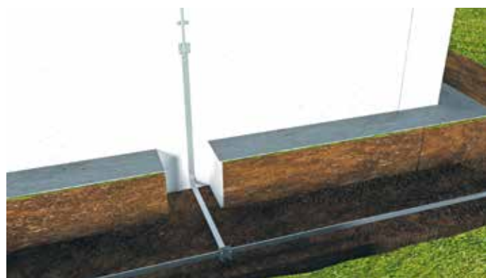
Заземлення струмоспуску шляхом підключення до контуру заземлення Grounding a current release by connecting to a ground loop
