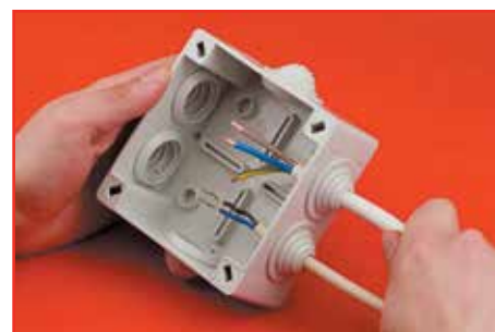
Етап 3. Введення кабелю Step 3. Insertion of cable
