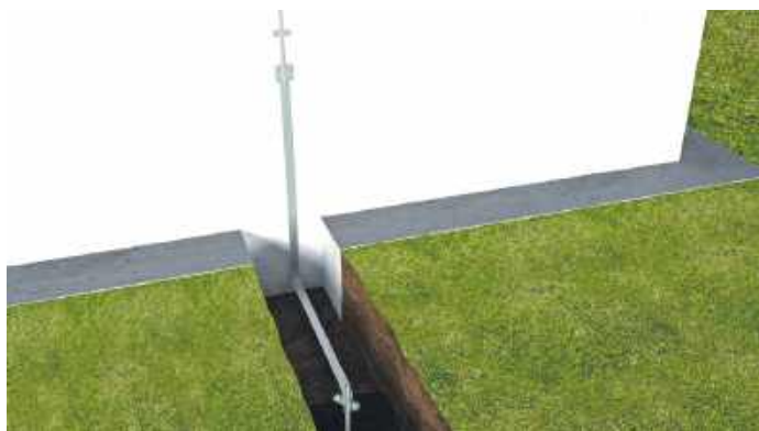
Заземлення струмоспуску Grounding the current release
