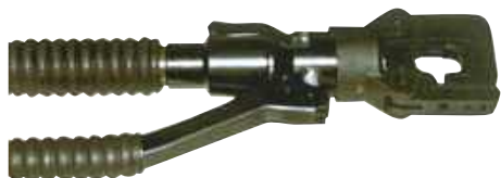
Код 2ART55 Кліщі гідравлічні Code 2ART55 Hydraulic pliers
