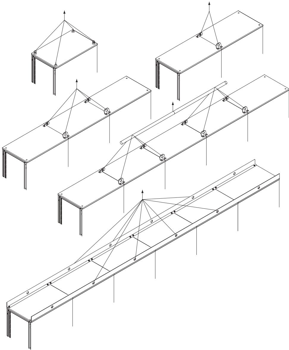
Схеми на рисунку для шаф з рівномірним розподілом ваги по всій ширині транспортованої збірки шаф.
